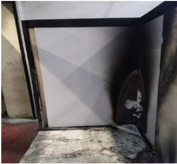
Fotoğraf 3. Numune 1'e ait deney sonrası uzun kanat detayı
